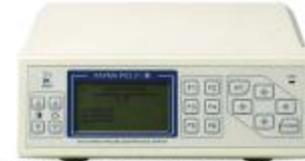
Прибор для проверки качества электрической энергии.
