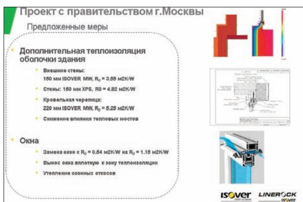
Рис. 2. Меры по снижению энергопотребления при реконструкции
