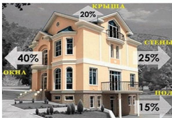
Рис. 2. Теплотери в здании
