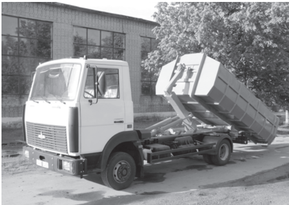
Рис. 1. Мусоровоз контейнерный с механизмом погрузочно-разгрузочным МПР-4 (типа мультилифт):
