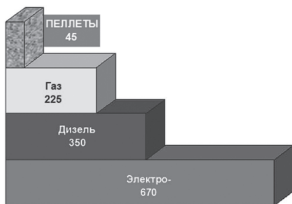
Сравнительный график выброса CO 2 в атмосферу различных отопительных систем
