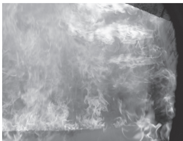
Рис. 3. Образец газификационного горения в топке Calidum Ember. На правой стороне видны факелы вторичного горения газифицированного топлива в местах, где вдувается вторичный воздух. Газификационное горение позволяет распределить горение в большем объеме топки и этим предотвратить появление высоких температур пламени
