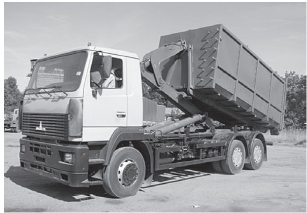
Рис. 2. Мусоровоз контейнерный с механизмом погрузочно-разгрузочным МПР-3 (типа мультилифт):
