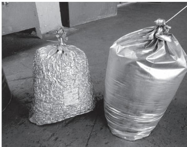
Рис. 8. Продукция одного веса, упакованная в вакуумную упаковку (слева) и в обычную (справа)
