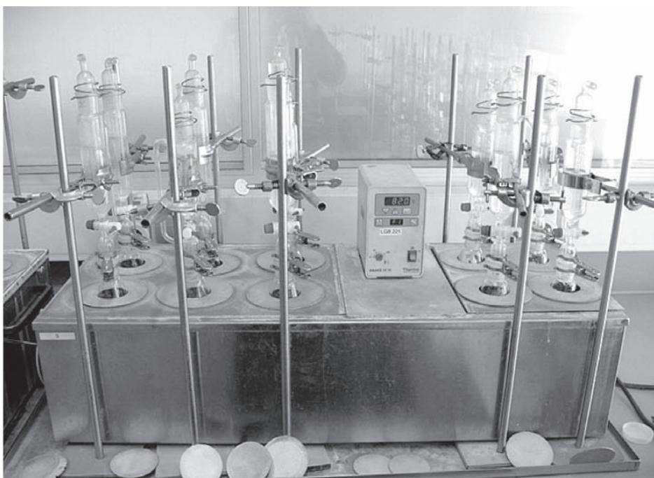
Рис. 8. Метод испытания для определения стабильности алюминиевых паст
