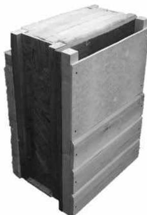
Толщина утеплителя 450 мм
