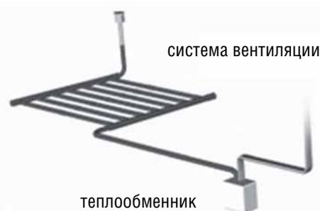
**Рис. 8.** Схема устройства грунтового теплообменника
