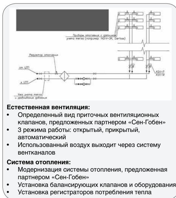
Рис. 6. Предложение по оптимизации систем вентиляции и отопления существующего здания
