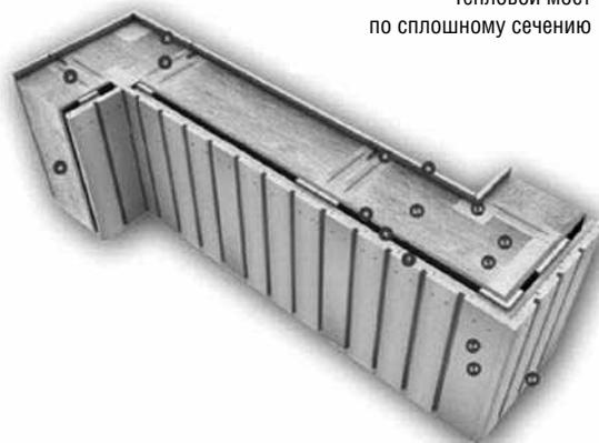
**Рис. 4.** «Мостики холода» в конструкции
