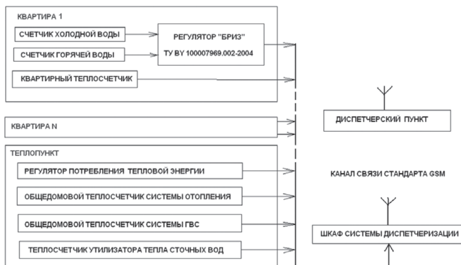
Рис. 3. Функциональная схема системы диспетчеризации энергоэффективного здания
