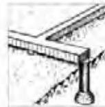
• Свайный фундамент с ростверком позволил сократить расходы при бетонировании и последующей утилизации (по истечению срока эксплуатации здания) бетона в 3 раза, а также соответствовать принципу минимального вмешательства в окружающую среду
