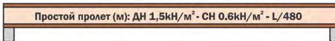
**Перекрываемый пролёт – до 8,3 м (без промежуточных опор)**
