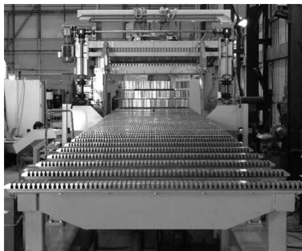
Рис. 4. Резательный стол HFC-2 с двигающимися мостами
