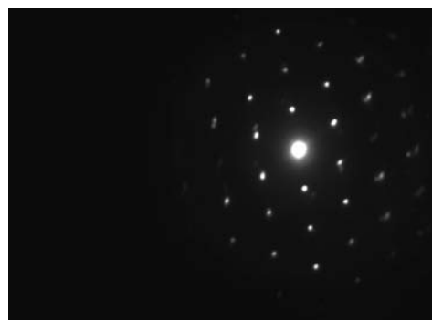
Рис. 17. Микродифракция пластины монокристалла гипса образца ячеистого бетона с добавкой гипсового камня
