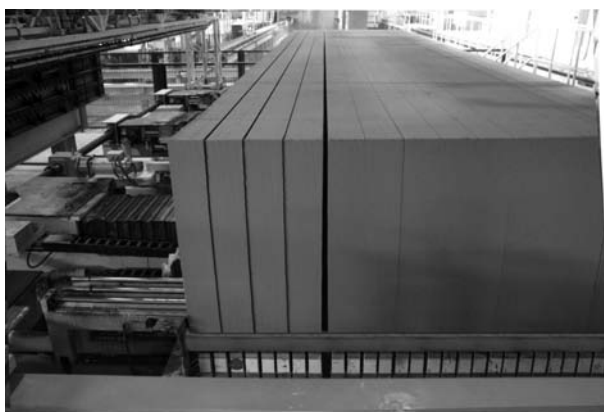
Рис. 1. Установка разделения сырого массива полностью исключает склеивание разрезов в процессе автоклавирования
