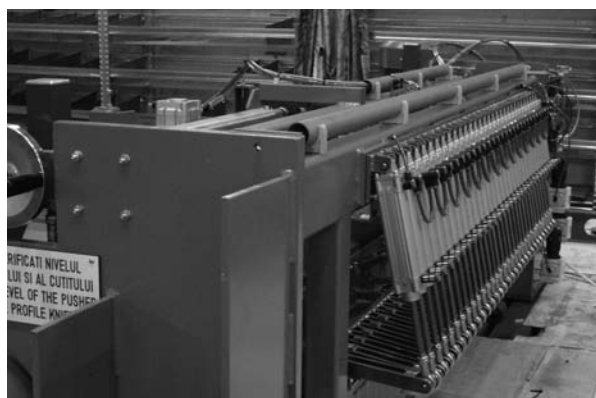
Рис. 2. Продольная резка с системой пневматического натяжения струн
