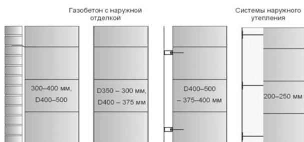
Рис. 1. Основные варианты стеновых заполнений с применением кладки из автоклавных газобетонных блоков в монолитном строительстве Санкт-Петербурга
