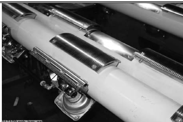
Рис. 1. Двойные качающиеся валы с пневматической системой натяжения струн
