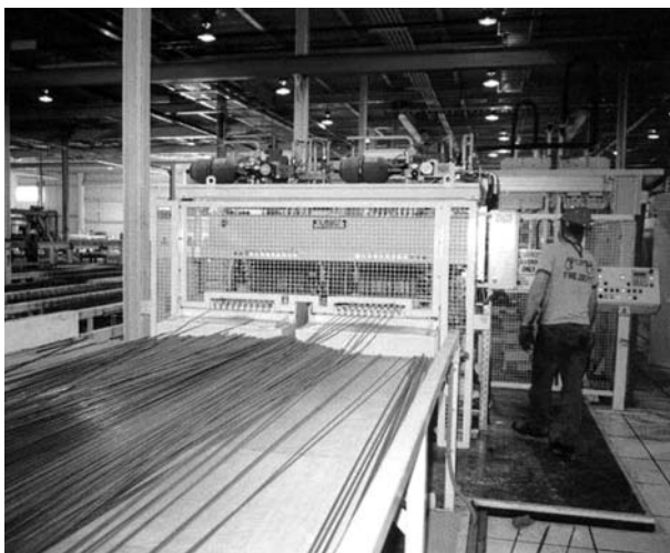
Рис. 5. Автоматическая сварка арматурных сеток
