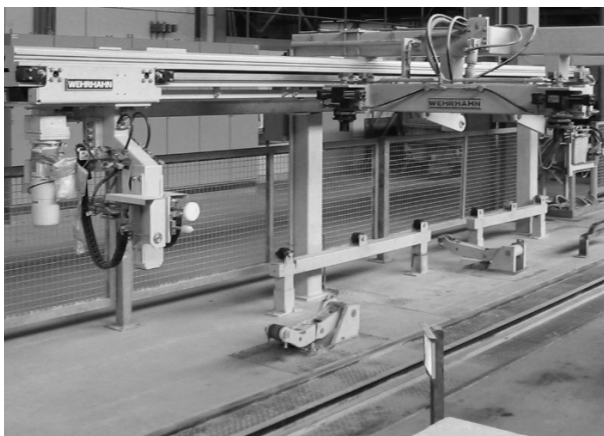
Рис. 2. Установка тестирования массива перед резкой на установке открывания и закрывания форм
