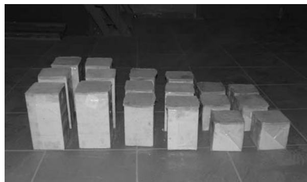
Рис. 1. Образцы AAC, подготовленные для изучения кинетики высыхания
