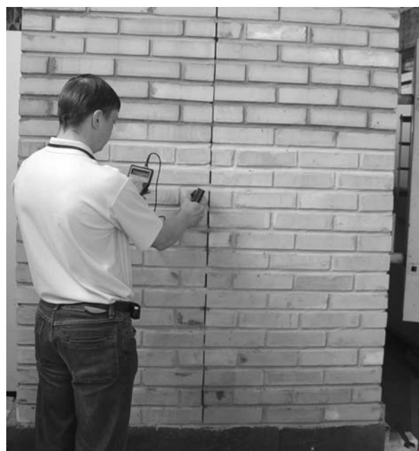
Фото 3. Испытания на прочность методом ударного импульса
