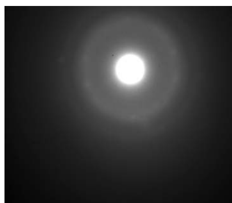
Рис. 14. Микродифракция игольчатых кристаллов образца ячеистого бетона с добавкой гипсового камня
