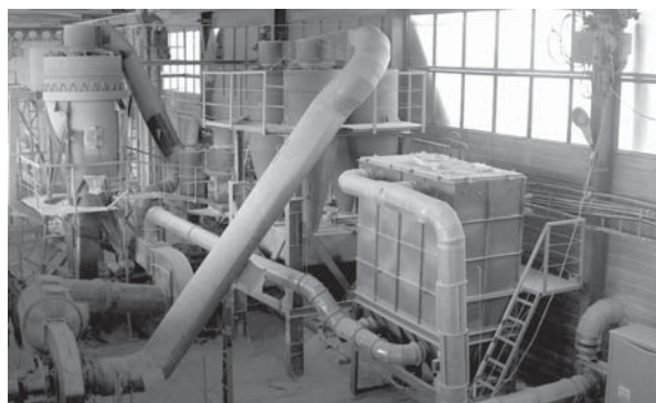
Рис. 7. Измельчительно-классифицирующий комплекс для производства тонкодисперсного мела на базе дезинтегратора и центробежных классификаторов
