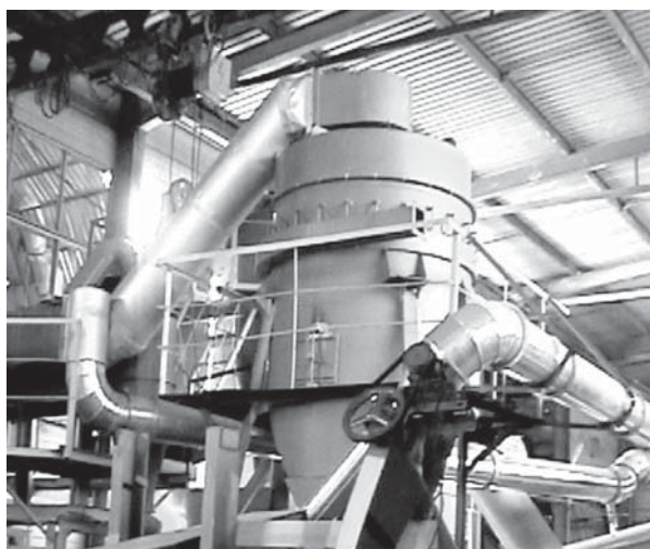
Рис. 5. Центробежные классификаторы КЦС-10 и КЦД-5 соответственно
