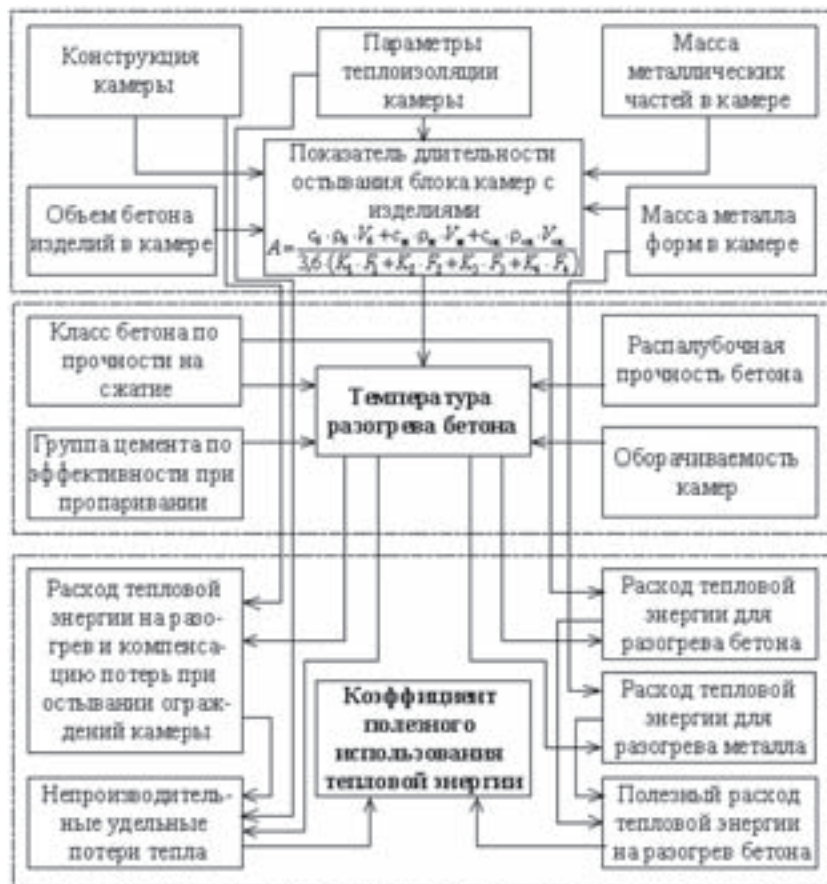
Рис. 3. Схема расчета термосных режимов тепловлажностной обработки тяжелого бетона по ТКП 45-5.03-13-2005
