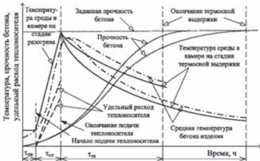
Рис. 2. Энергосберегающий режим тепловлажностной обработки бетона
