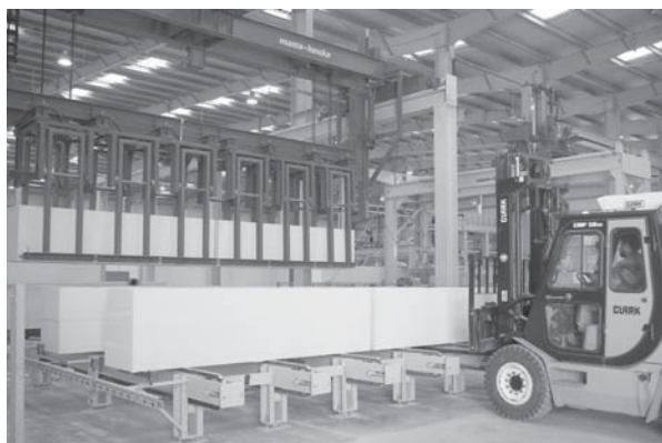
Рис. 14. Готовые армированные элементы (внутренние перегородки этажной высоты) – по пути на склад
