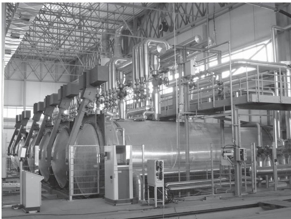
Рис. 8. Зона запаривания с автоклавами оснащена автоматическим управлением для достижения оптимального качества продукции
