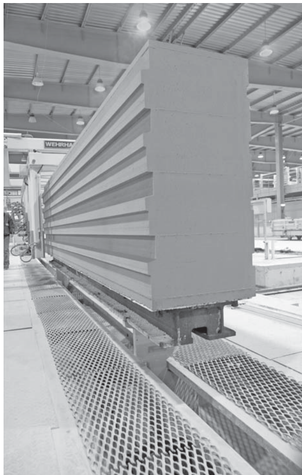
Рис. 4. Профилирование армированных плит на высокоточной линии резки Wehrhahn
