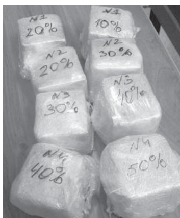
Рис. 5. Общий вид образцов и экспериментальной установки для определения коэффициентов термовлажностопроводности
