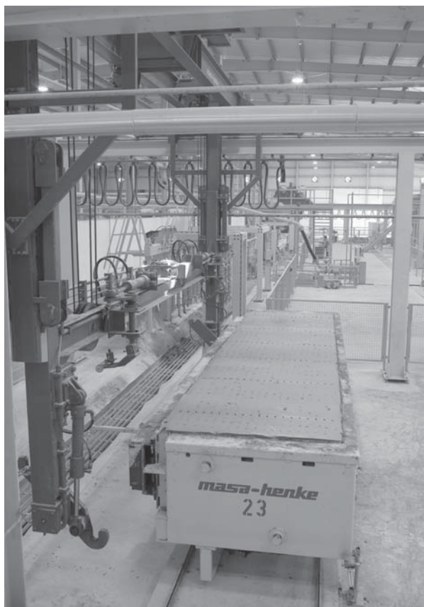
Рис. 6. Линия резки разделена на три рабочих станции, что обеспечивает оптимальную точность конечной продукции. При помощи крана-кантователя осуществляется распалубка свежесформованного массива и его перемещение на резательную тележку
