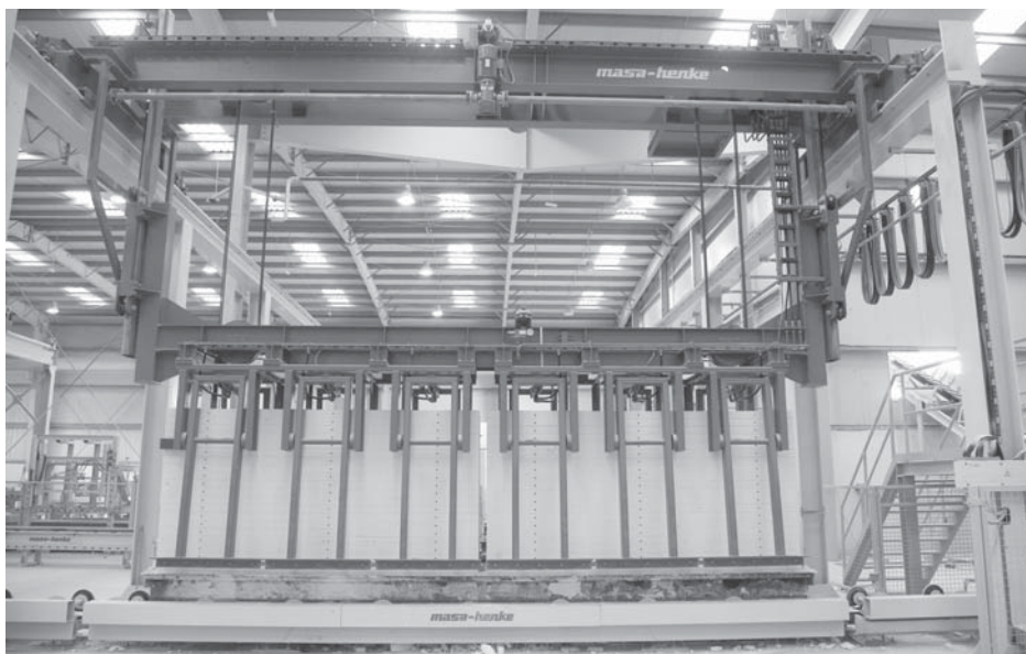
Рис. 13. При помощи устройства перестановки блоков, принадлежащего к линии «ВАРИО БЛОК», армированные элементы подаются на отдельный участок упаковки
