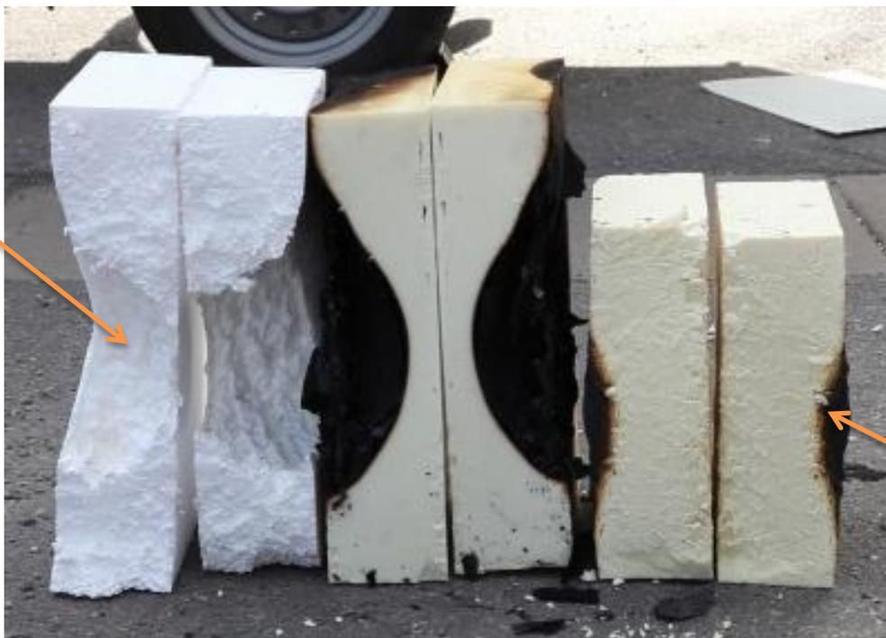
Пенополиизоцианурат не поддерживает горение, материал не плавится, допустимый температурный режим эксплуатации до 180°C
