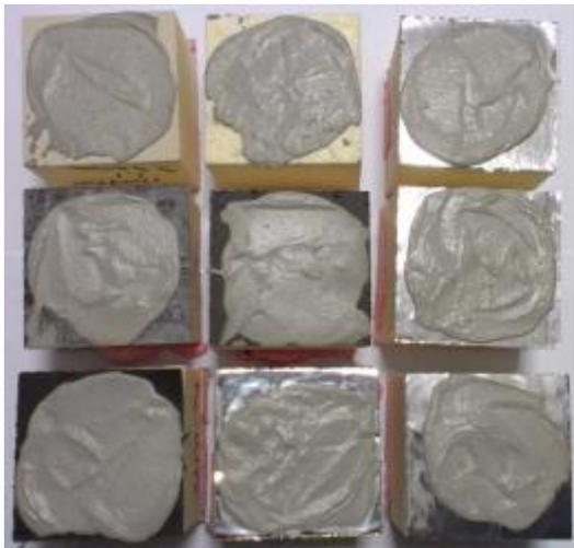
Полиуретановый клей обладает хорошими адгезионными свойствами ко всем видам облицовочных материалов, используемых при производстве плит теплоизоляции.
