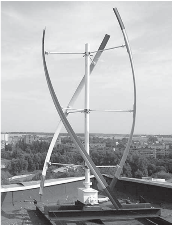
Рис. 3. Геликоидный ветроротор с желобчатыми лопастями в Барани, Беларусь (фото Александра Кучерявого)
