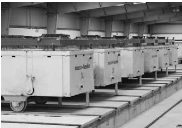
Рис. 4. Заполненные формы в зоне созревания: более низкая высота цеха в зоне созревания позволила улучшить тепловой баланс и понизить расход энергии для зоны созревания, а также сократить расходы при строительстве. Данная концепция установки предполагает использование тепла от конденсата для отопления зоны созревания в холодное время года. Если производятся армированные изделия, рамы остаются на формах, обеспечивая надежное позиционирование арматурных каркасов
