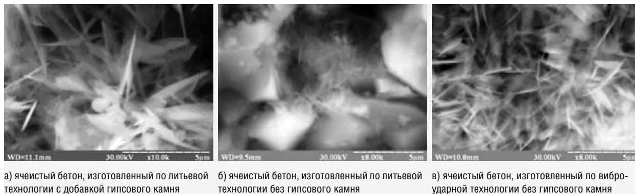
Рис. 3. Микроструктура межпоровой перегородки газобетона
