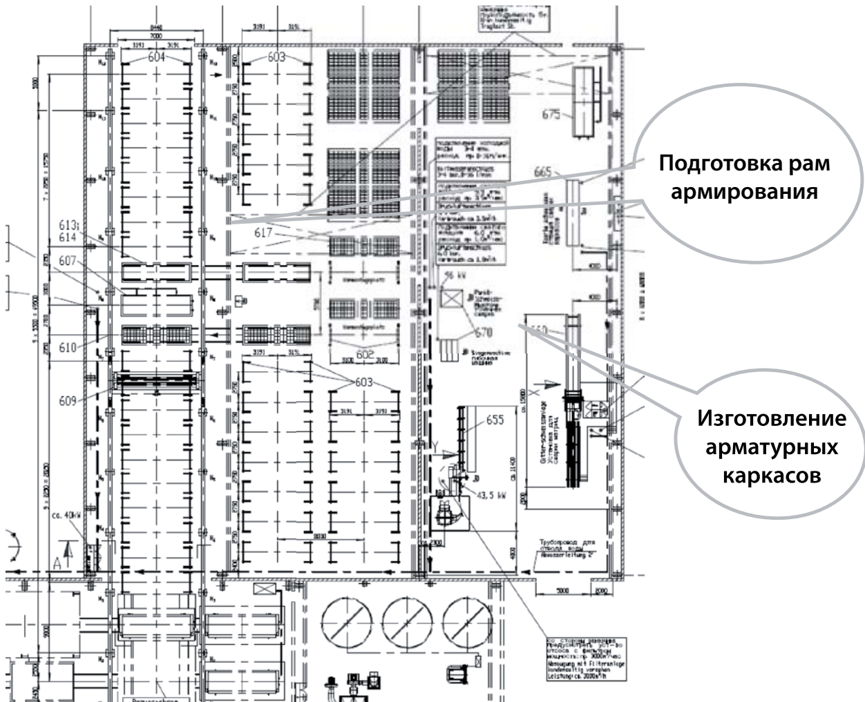
Рис. 1. Схема интеграции установки для производства армированных изделий в линию «Варио-Блок»
