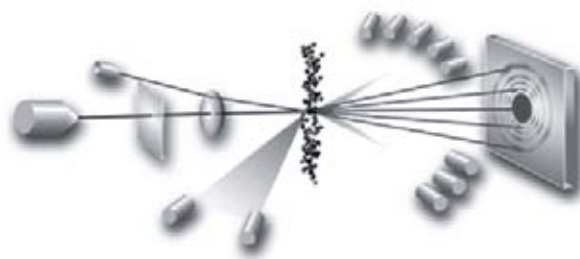
Рис. 4. Принцип работы лазерного дифракционного микроанализатора
