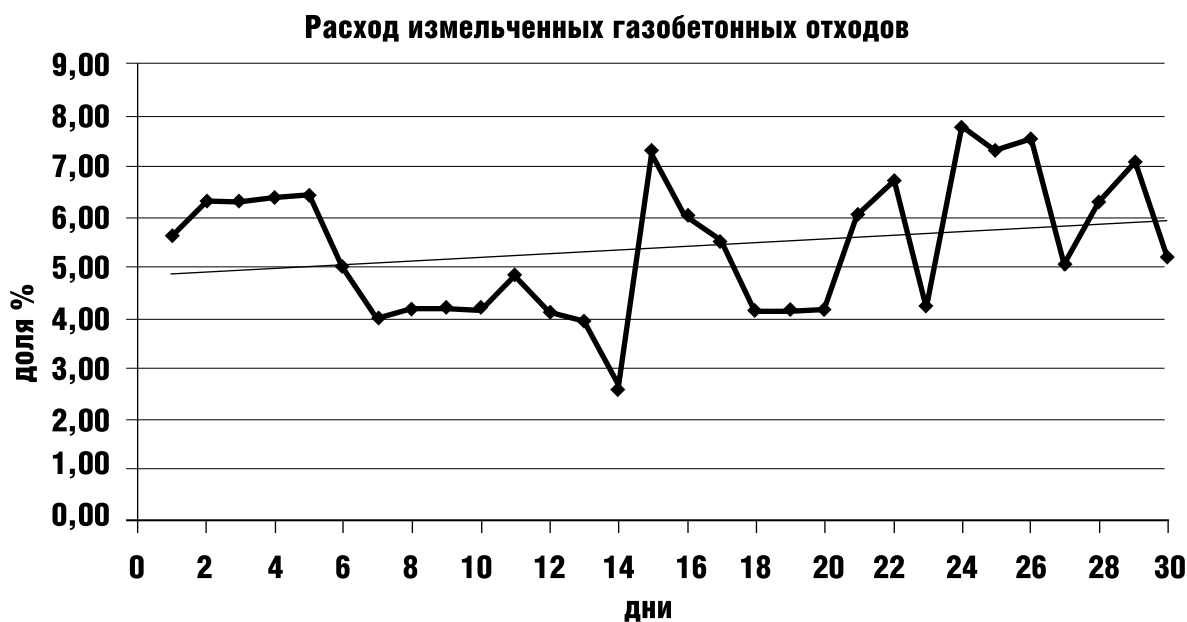
Рис. 7. Зафиксированные данные по расходу измельченных газобетонных отходов в течение 1 месяца производства. Количество материала, подаваемого обратно в технологический процесс, зависит от вида производимых изделий
