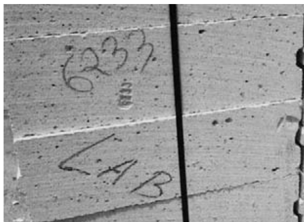
Рис. 2. Газобетонные блоки, полученные в результате использования пудры, содержащей сваренные алюминиевые частицы
