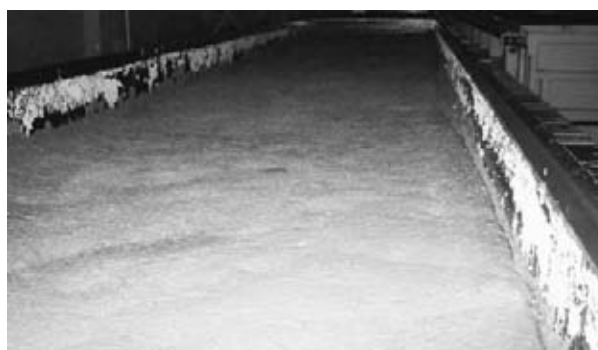
Рис. 3. Газобетонный массив, полученный в результате использования некачественного газообразователя
