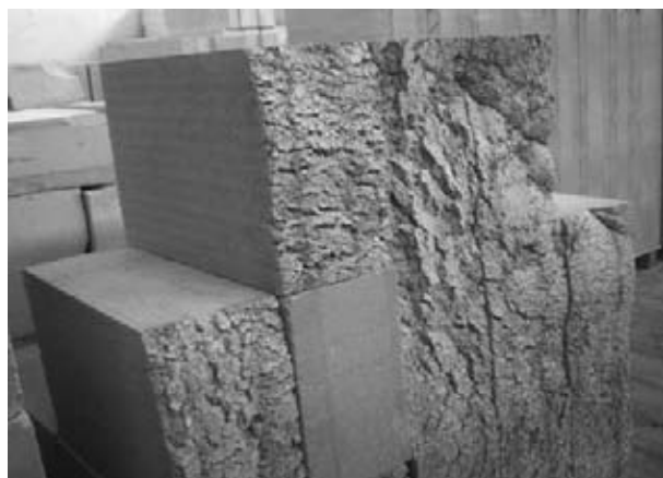
Рис. 1. Некондиционные газобетонные блоки, полученные в результате использования некачественного газообразователя
