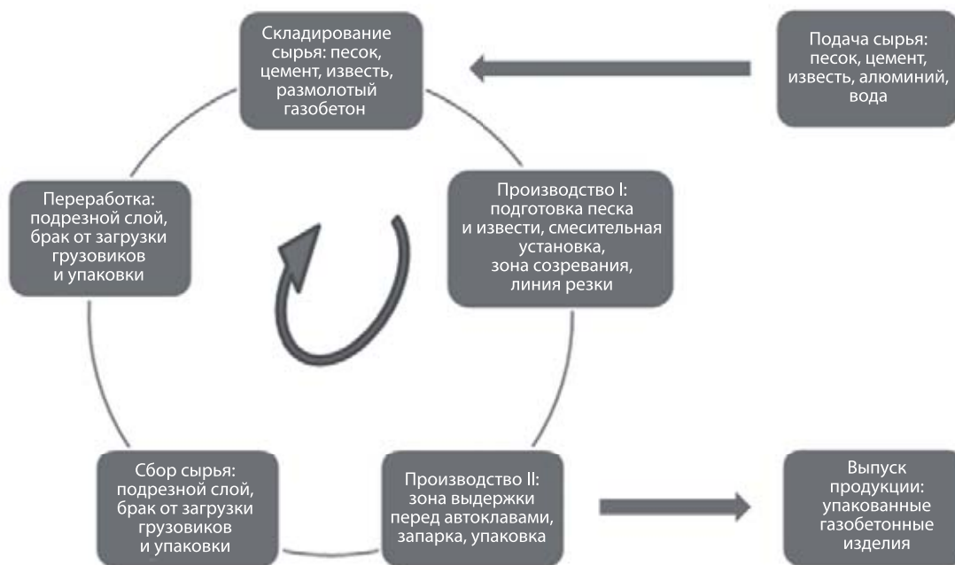
Рис. 6. В основной технологической схеме, разработанной фирмой «Маза» для обратной подачи сырья, представлена специальная установка переработки/ измельчения материала
