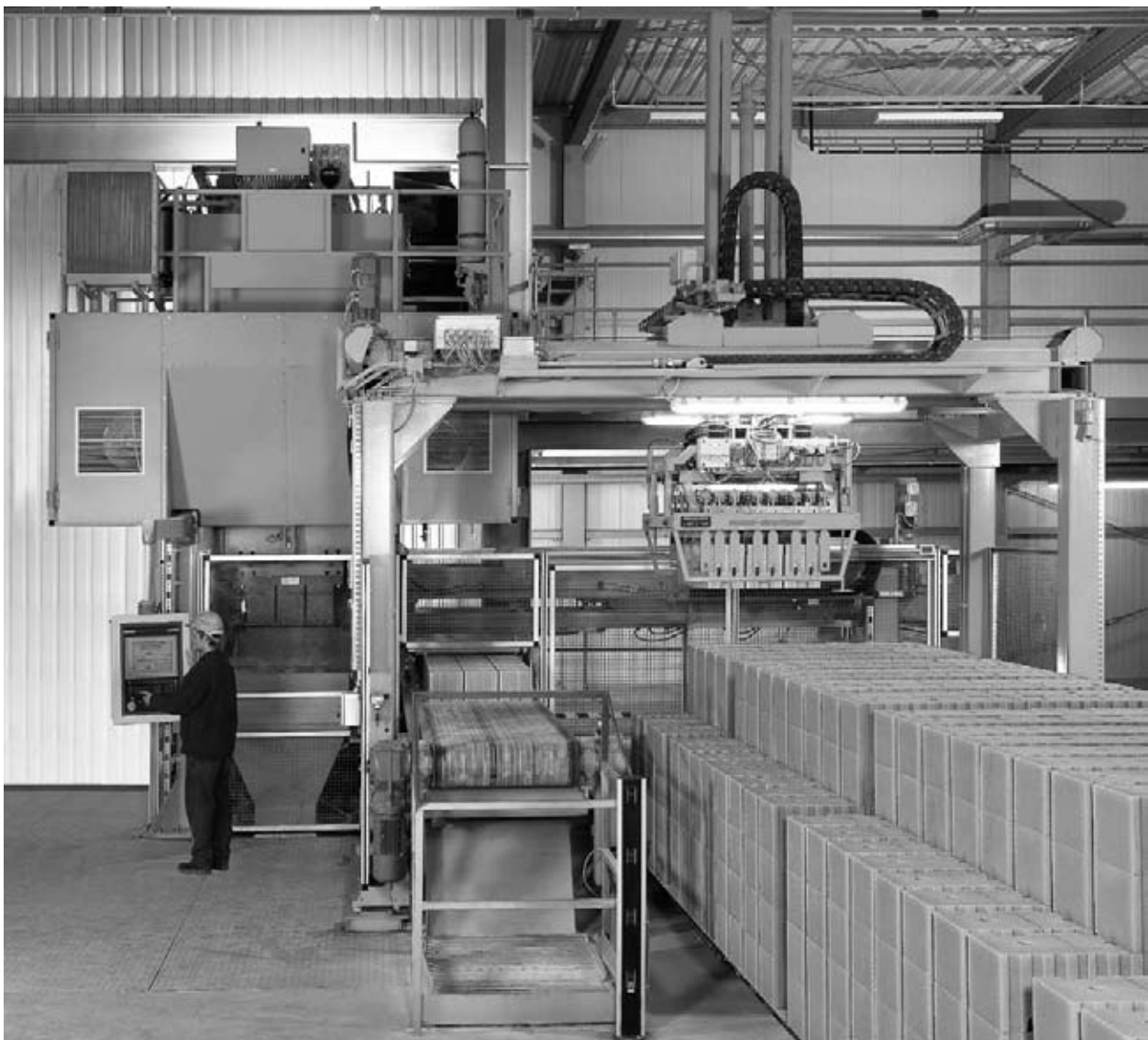
Рис.11. Современный гидравлический пресс с двухсторонним уплотнением, тип HDP 800
