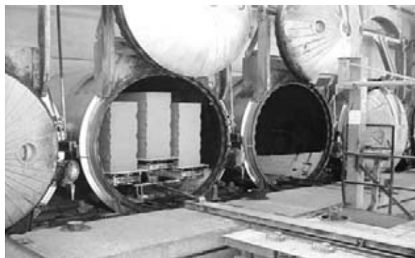
Рис. 1. Набор прочности газобетоном в автоклавах
